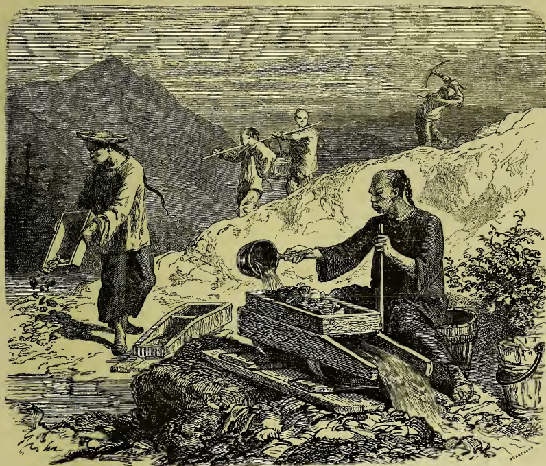
Fig. 144. — Chinois lavant les sables aurifères avec le berceau sur les placers d'Australie.
